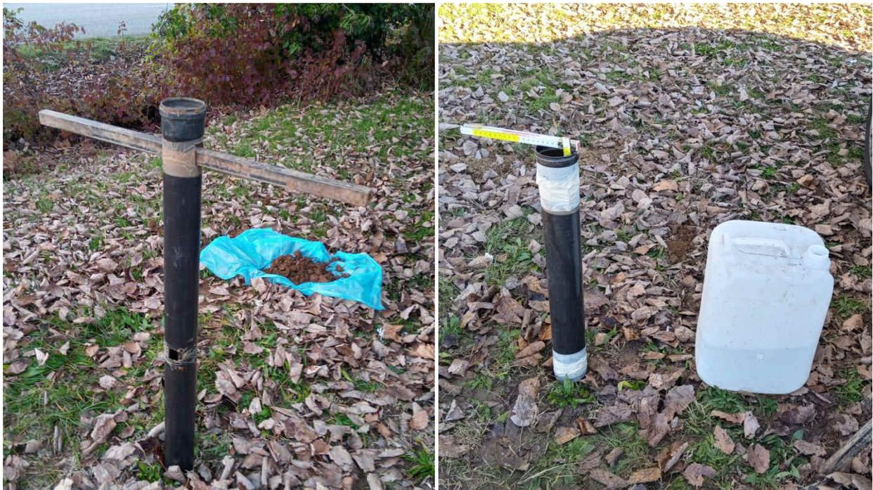
**Figura 16** Perforazione con carotiere manuale e prelievo di campioni rimaneggiati.
