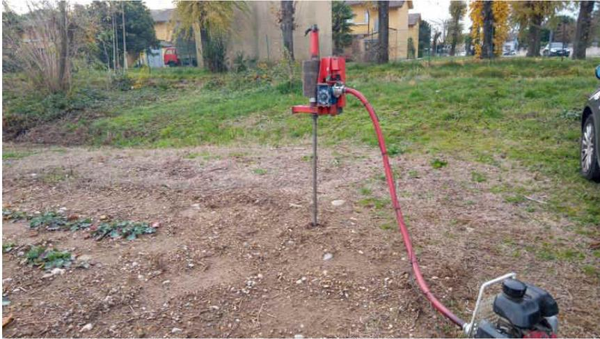
Figura 7 Foto prova penetrometrica 1
