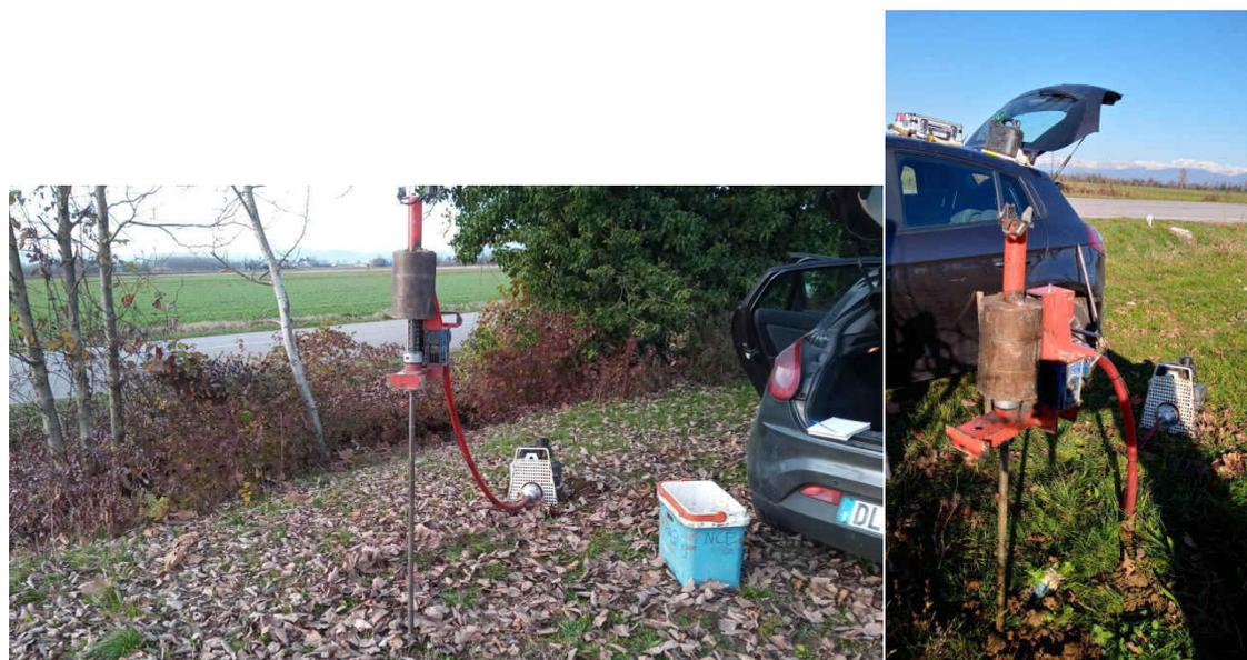
Figura 9 Foto prova penetrometrica 3 (sin) e 4 (dx)
