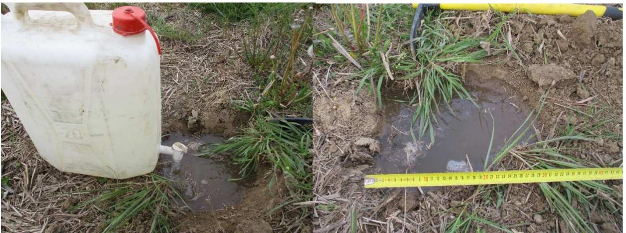
prova di infiltrazione in superficie Percoto
